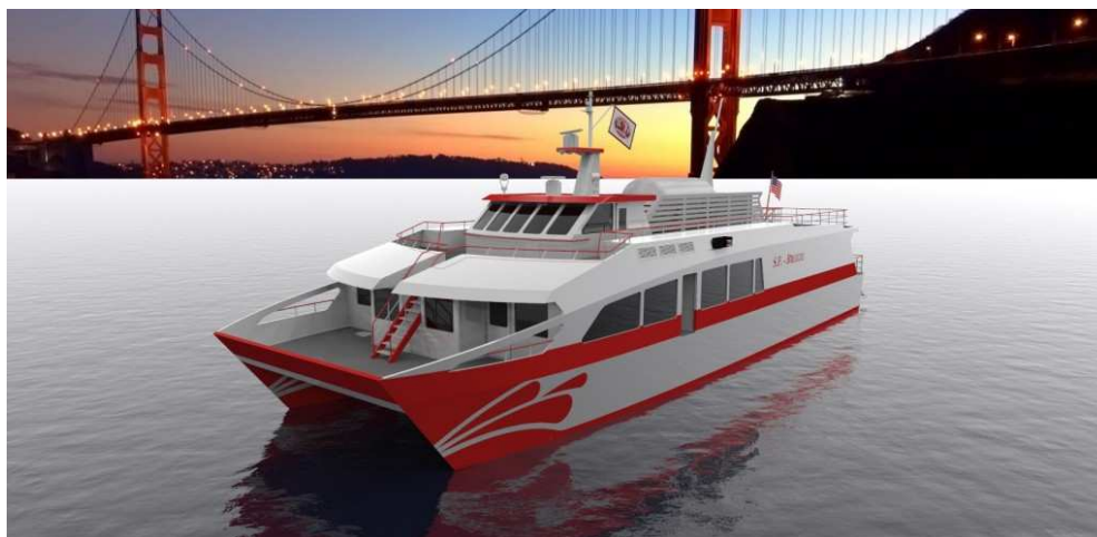
Figur 12 Hurtigbåt med flytende hydrogen. Fra prosjekt San Francisco Bay Renewable Energy Electric vessel with Zero Emissions (SF-BREEZE) 49
