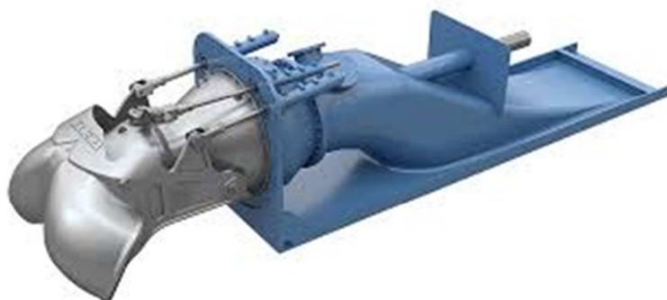
Figur 4-12: Vannjett med vanninntak, styredyse og reverseringsspjeld (kilde: Rolls Royce)
