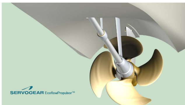
Figur 4-11: Vribar propell i skrogtunell (kilde: Servogear)
