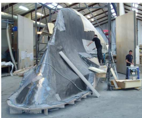
Figur 4-4: Karbonsandwichskrog, tørr karbonduk og delvis PVC kjerne på hannform
